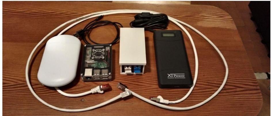
Il s'agit d'un projet de création de kit facilement transportable afin de tester sur le terrain l'éligibilité au réseau radio de SCANI, et même de mesurer le débit directement lors de l'exploration sur le terrain !
